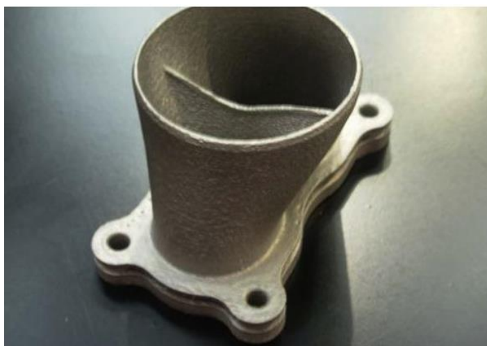
3 - сурет - Титан қорытпасынан жасалған бөлшектердің макеті
