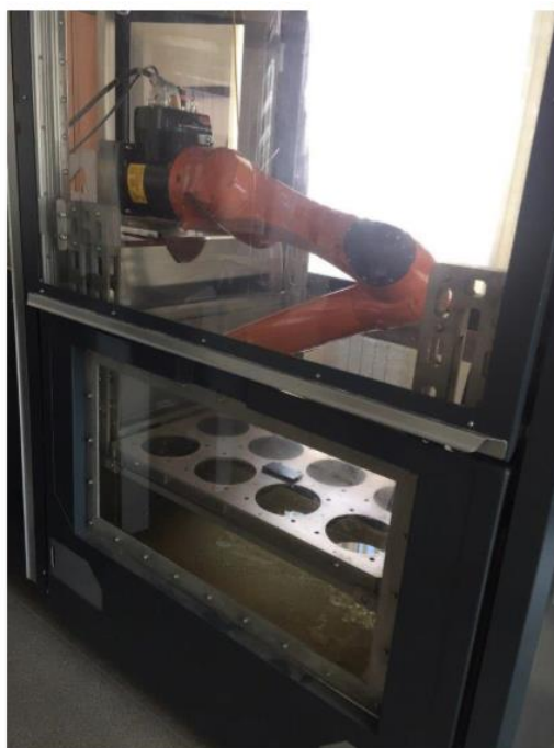
14 - сурет - Роботталған ультрадыбыстық томография
